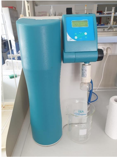
Slika 45. Uređaj za ultračistu vodu.
