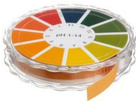
Slika 5. Univerzalni indikator papir [10].
