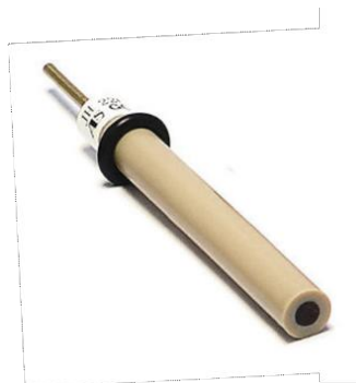
Slika 7. Radna elektroda od staklastog ugljika.
