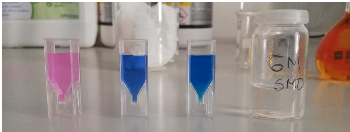
Slika 22. Otopine boja pomiješane s koloidnom disperzijom uzorka SMO_6M prije fotokatalitičkih mjerenja.
