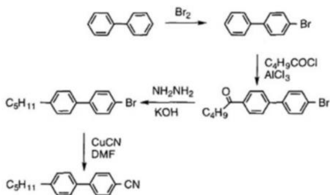
Slika 13. Sinteza 4-cijano-4'-pentilbifenila (Slika preuzeta iz P. J. Collings, M. Hird, Introduction to Liquid Crystals Chemistry and Physics , Taylor & Francis, 2009.)
