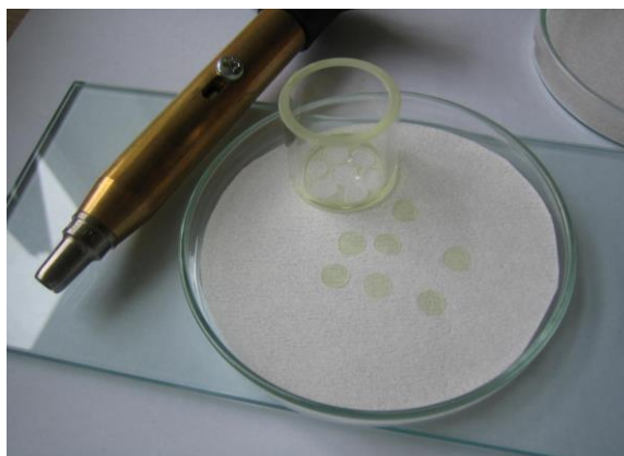
Slika 7. Izrada membrane ionsko selektivne elektrode[1]
