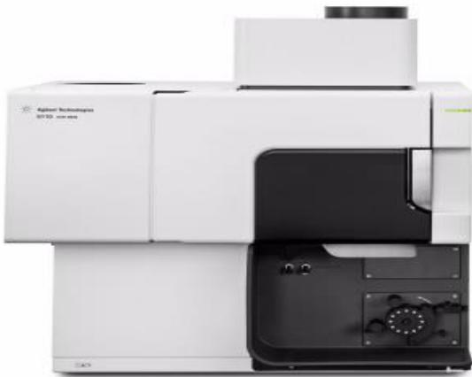
*Slika 17. Uređaj za analizu elemenata u tragovima optičkom emisijskom spektroskopijom s induktivno spregnutom plazmom [30]*
