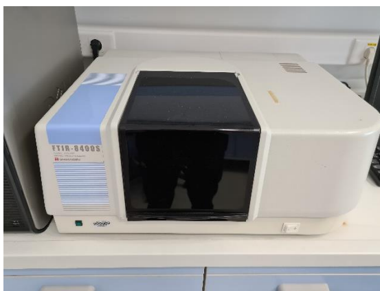
Slika 8: Spektroskop Shimadzu FTIR 8400S.
