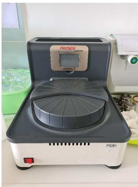
Slika 9: Planetarni kuglični mlin Fritsch Pulverisette Premium 7.
