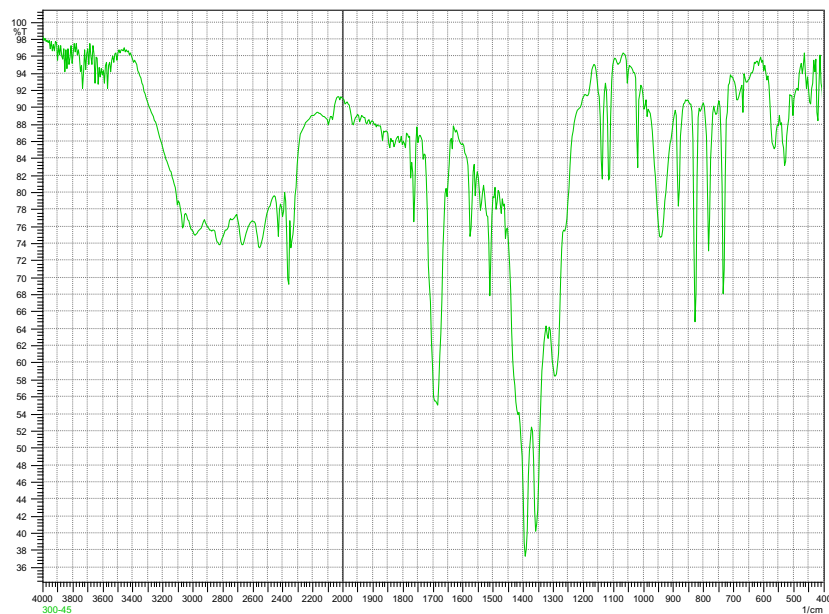
Slika 16: FTIR spektar MOF-5 sintetiziranog 45 min na 300 rpm.
