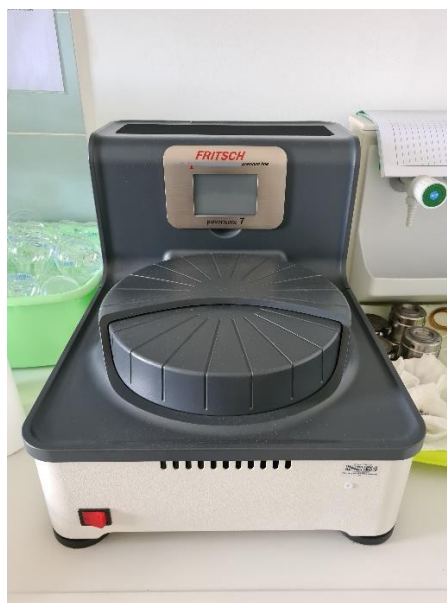
Slika 9: Planetarni kuglični mlin Fritsch Pulverisette Premium 7.
