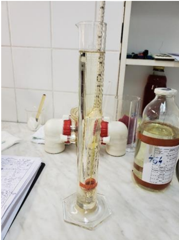
Slika 5. Mjerenje gustoće ulja.
