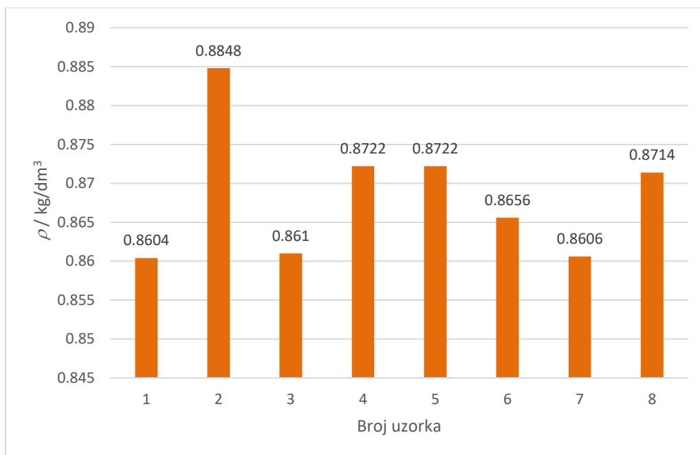
Slika 9. Grafički prikaz gustoće ispitivanih uzoraka ulja određenih pri 20 °C.
