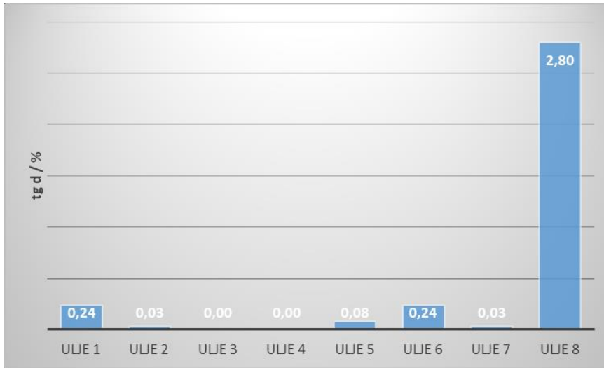
Slika 16. Grafički prikaz ispitivanja koeficijenta dielektričnih gubitaka.
