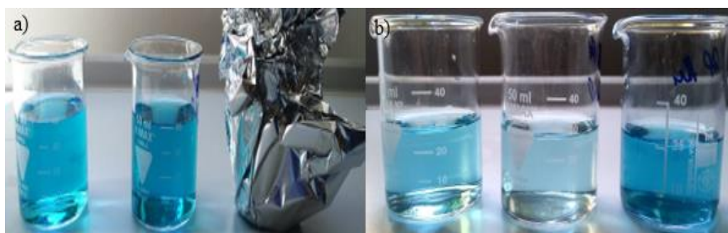
Slika 81. a) Serija otopina metilen plavog s dodatkom CuH uzorka prije mjerenja fotokatalitičke aktivnosti; b) Serija otopina metilen plavog s dodatkom CuH uzorka nakon mjerenja fotokatalitičke aktivnosti u trajanju od 150 min.
