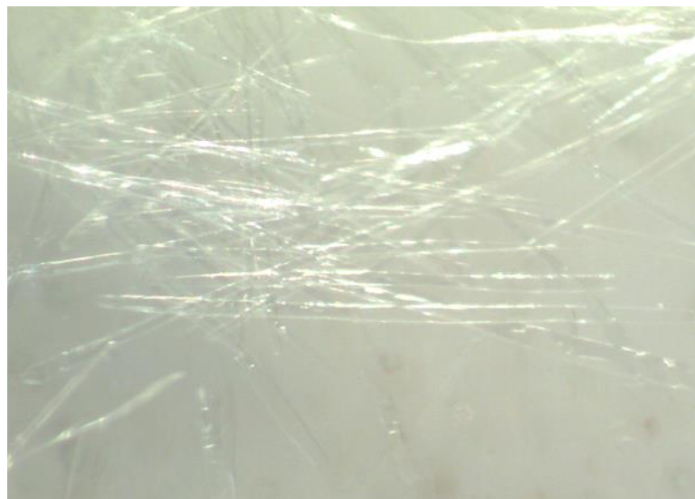
Slika 43. Igličasti kristali spoja Do5OH pripravljeni metodom evaporacije uz otapalo CAN
