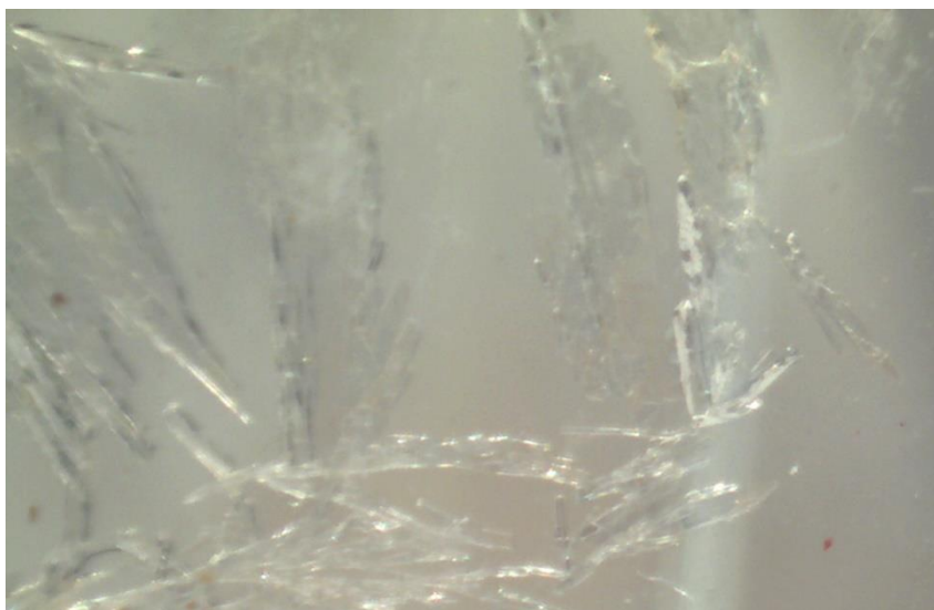
Slika 20. Jedinični kristal spoja Do3OH pripremljen metodom isparavanja uz otapalo benzen
