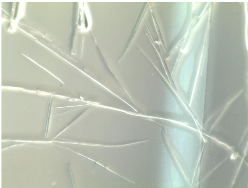
Slika 37. Igličasti kristali spoja Do4OH pripremljeni metodom difuzije para u sustavu CLF/nHAN
