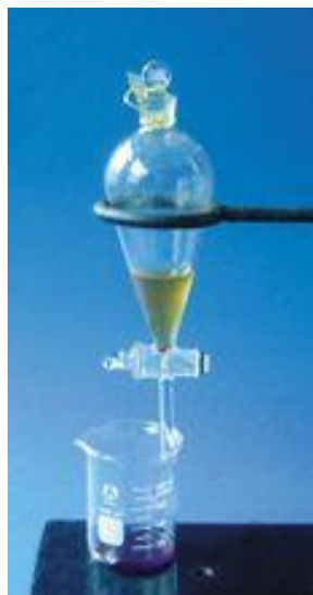
Slika 5: Aparatura za ekstrakciju [23]
