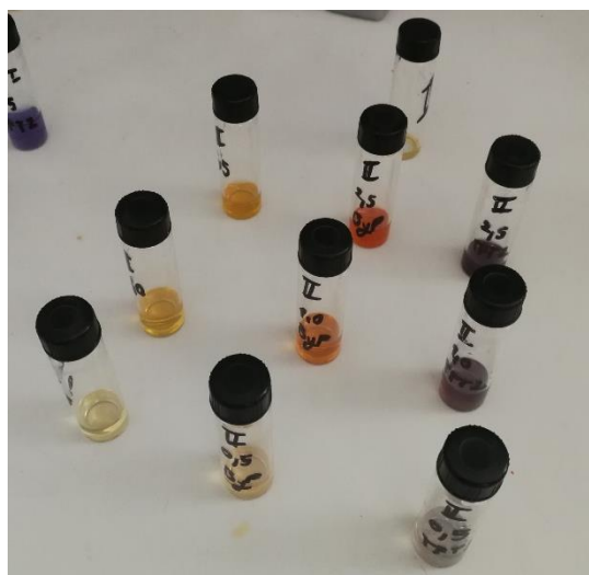
Slika 20. Priređene otopine P10-II hidrogela (lijevo), uz dodatak 2,2-bipiridina (sredina) i TPTZ (desno) pri različitim razrjeđenjima (II) nakon dodatka askorbinske kiseline.
