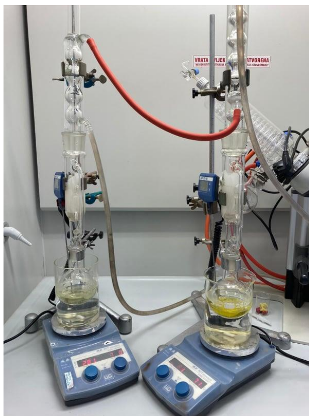
Slika 31. Aparatura za ekstrakciju Soxhlet metodom
