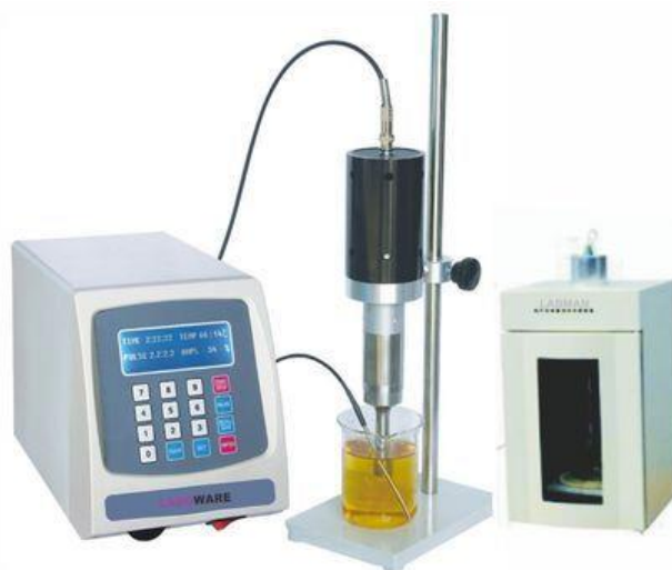
Slika 9. Prikaz aparature za ultrazvučnu ekstrakciju [36].
