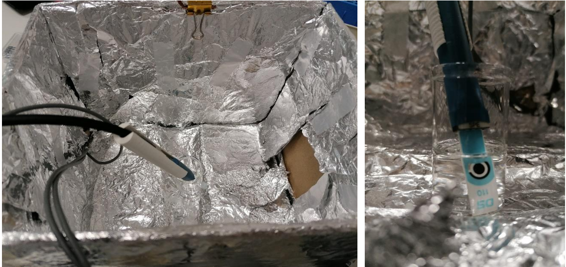
Slika 19. Sustav za amperometrijsko određivanje kalibracijske linije inzulina.
