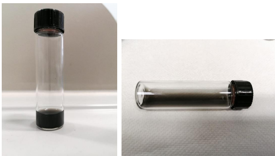
Slika 23. Kompozit kitozan–CNT i inzulin s reguliranim pH.
