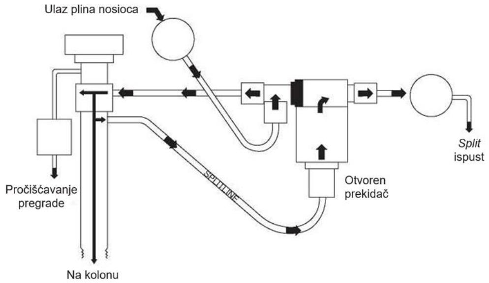
Slika 7. Shematski prikaz *split* injektor [10].
