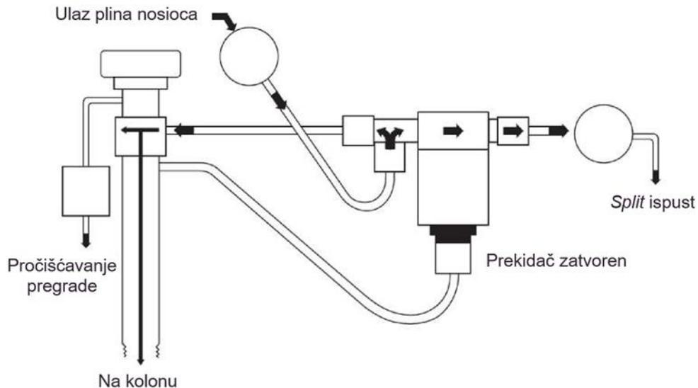
*Slika 8.* Shematski prikaz *splitless* injektora [10].
