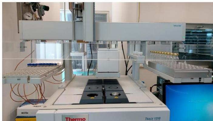
*Slika 13.* Plinski kromatograf TRACE 1310 s plameno-ionizacijskim detektorom (FID),
