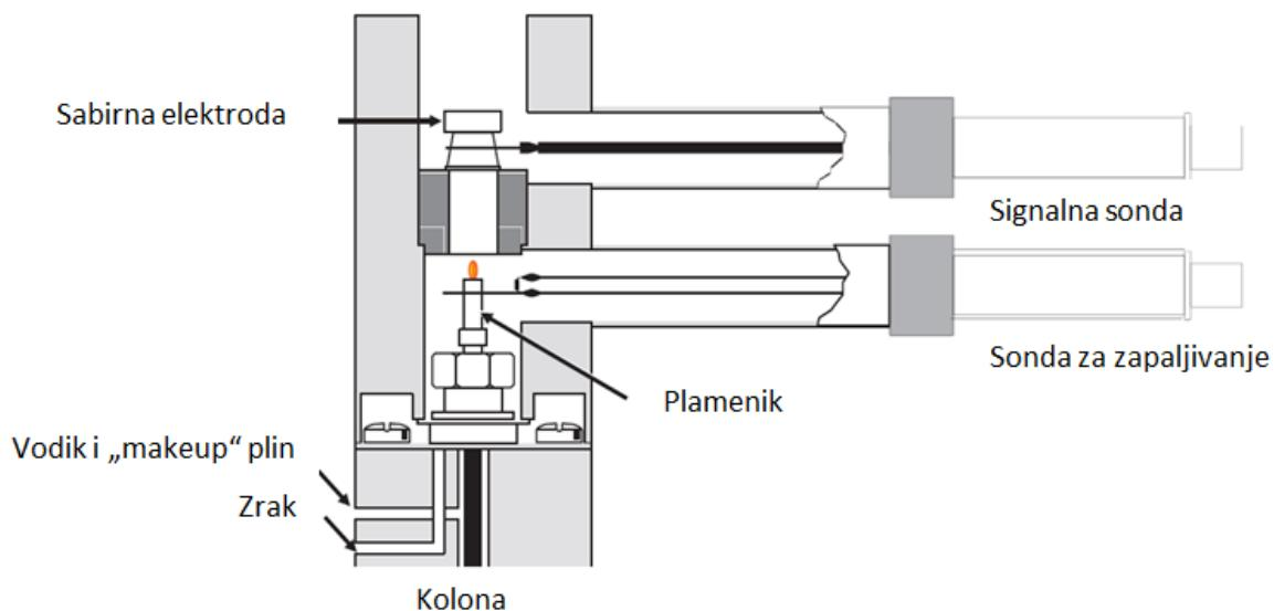
*Slika 11.* Poprečni presjek plameno-ionizacijskog detektora (FID) [10].
