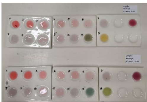
Slika 71. Rezultati primjene indikatora od svježe aronije i 50 % etanola (gore) i 75 % etanola (dolje).
