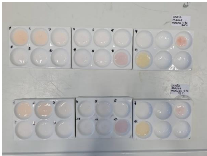
Slika 21. Rezultati primjene indikatora od svježe jagode i 50 % metanola (gore) i 75 % metanola (dolje).
