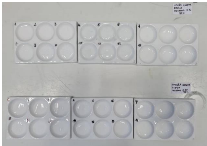
Slika 61. Rezultati primjene indikatora od svježeg crvenog ribiza i 50 % metanola (gore) i 75 % metanola (dolje).
