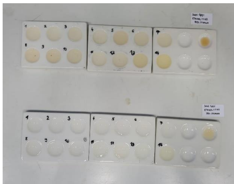
Slika 77. Rezultati primjene indikatora od suhe goji bobice i 50 % etanola (gore) i 75 % etanola (dolje).
