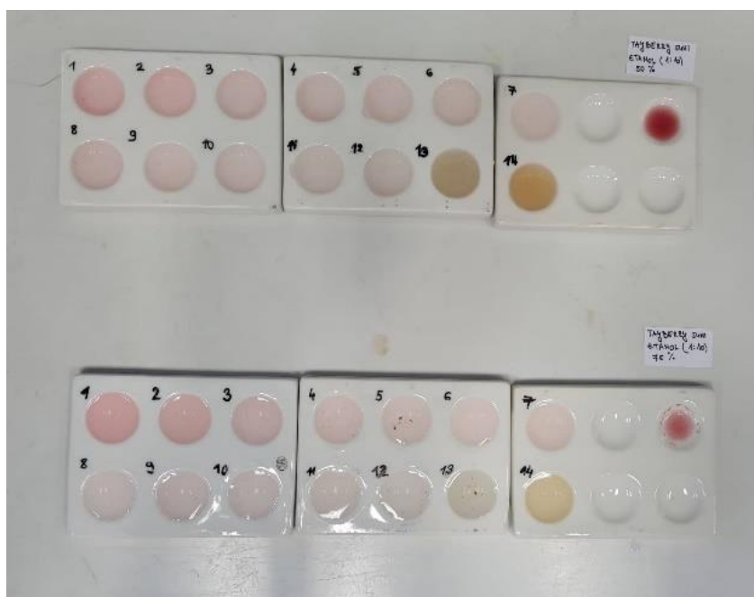
Slika 81. Rezultati primjene indikatora od suhih tayberry bobica i 50 % etanola (gore) i 75 % etanola (dolje).
