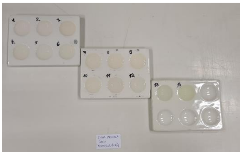
Slika 10. Alternativni kiselo-bazni indikator priređen od suhe aronije i acetona u omjerima a) 1 : 10, b) 1 : 15 i c) 1 : 20 nakon 24 sata.
