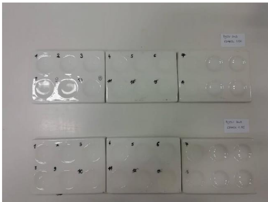
Slika 35. Rezultati primjene indikatora od svježeg bijelog duda i 50 % etanola (gore) i 75 % etanola (dolje).
