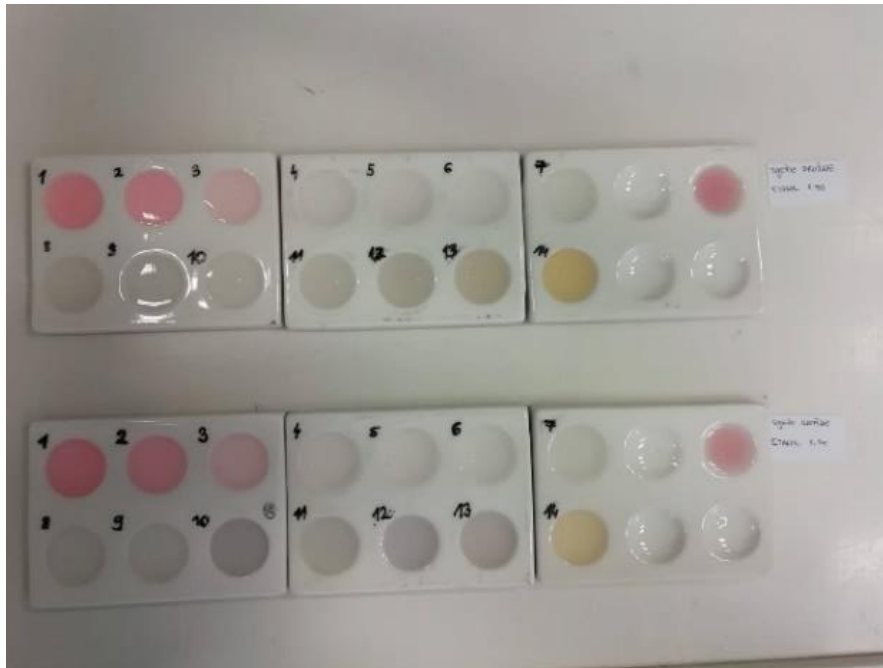
Slika 67. Rezultati primjene indikatora od svježeg Rose grožđa i 50 % etanola (gore) i 75 % etanola (dolje).
