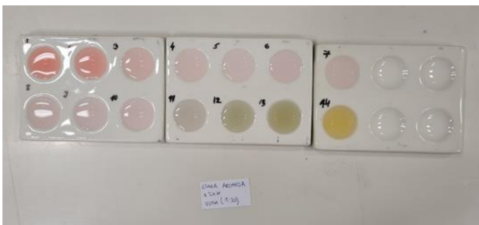
Slika 16. Alternativni kiselo-bazni indikator priređen od suhe aronije i vode u omjerima a) 1 : 10, b) 1 : 15 i c) 1 : 20 nakon 24 sata.
