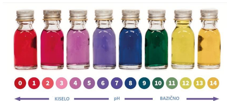
Slika 1. Promjene boje indikatora od crvenog kupusa pri različitim pH vrijednostima [5].
