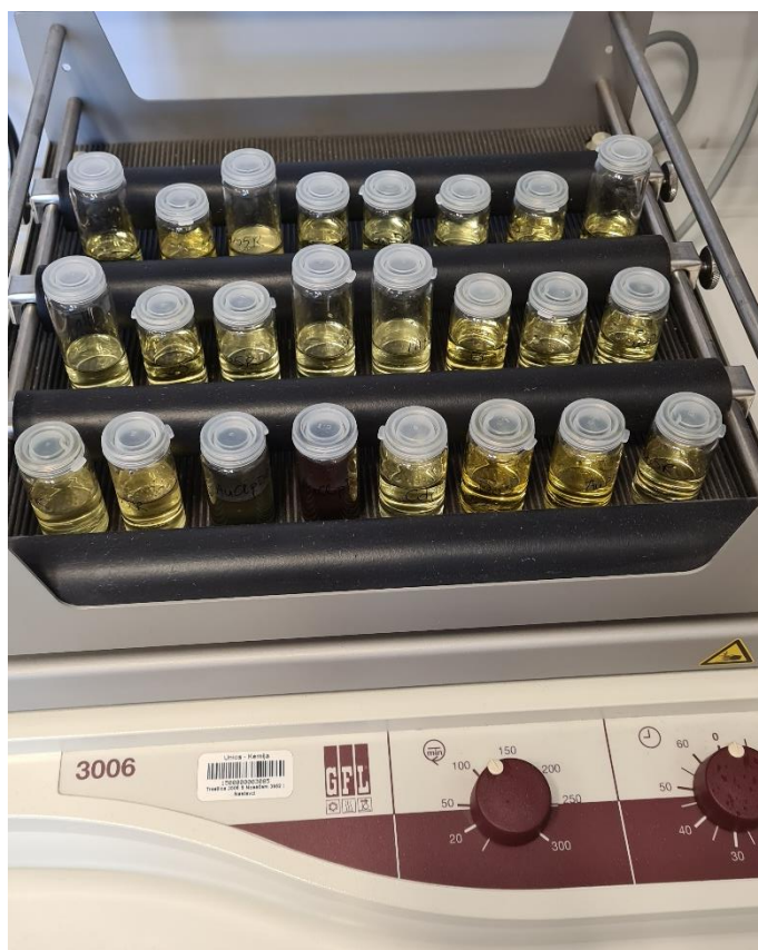
Slika 16. Pripremljeni uzorci na mehaničkoj tresilici.
