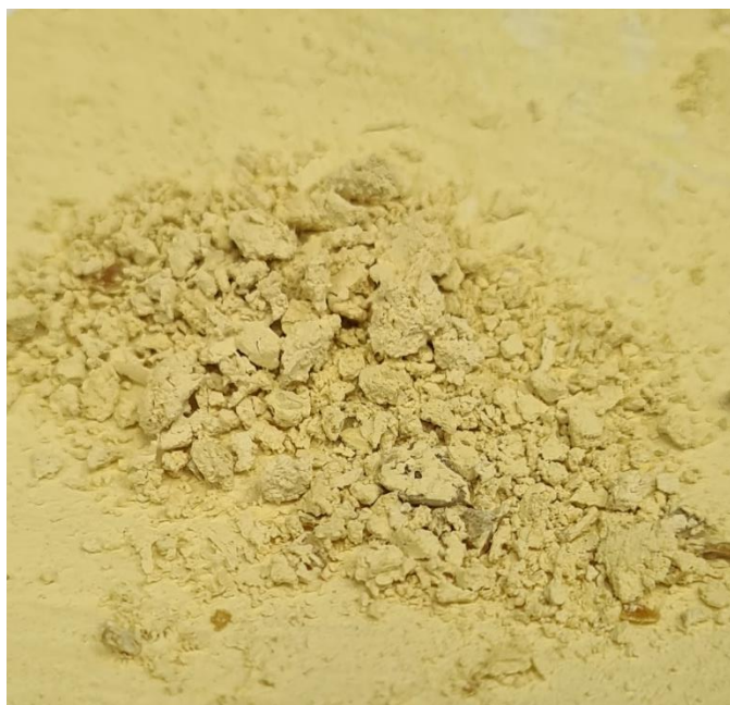
Slika 14. Kristali sintetizirane Schiffove baze pDo5.
