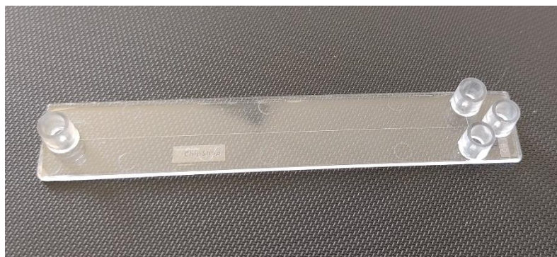
Slika 12. Mikročip korišten u elektroforetskim mjerenjima.
