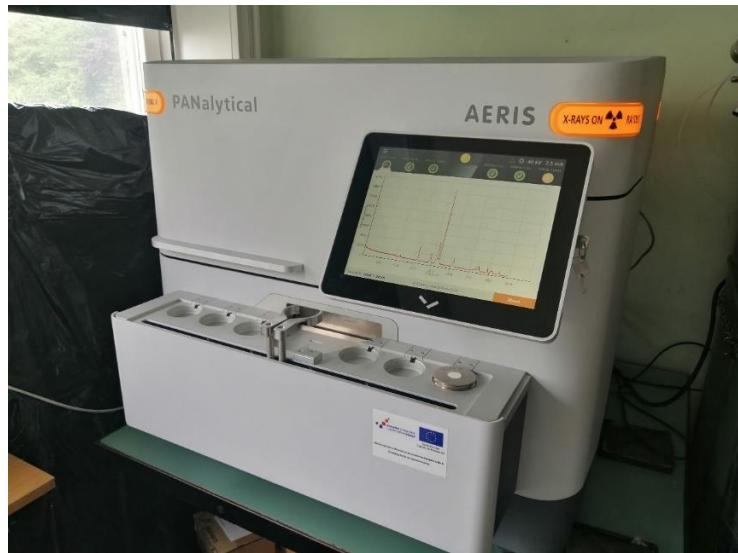
**Slika 3.3:** Uređaj za rendgensku difraciju na polikristalnom uzorku PANalytical Aeris.
