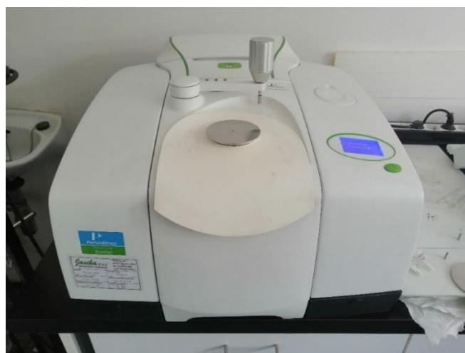
Slika 3.2:Uređaj za IR spektroskopiju PerkinElmer Frontier.
