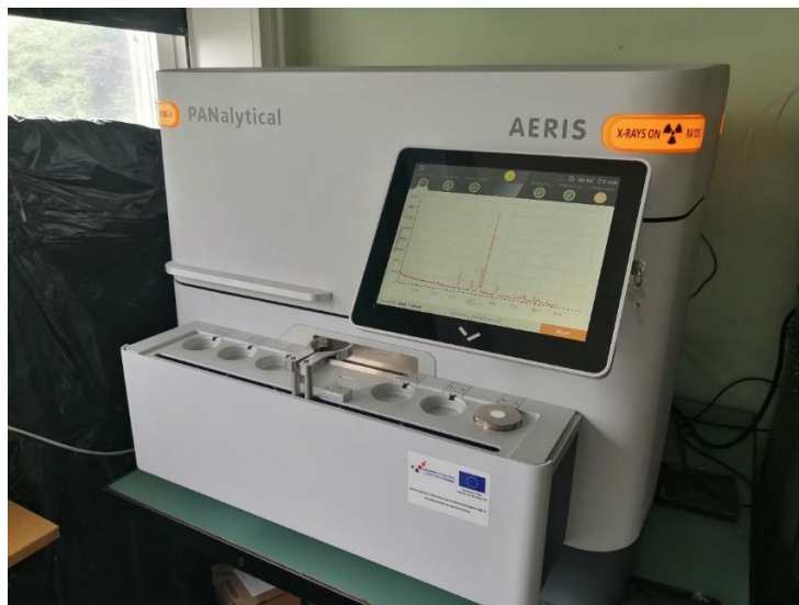
Slika 3.3: Uređaj za rendgensku difrakciju na polikristalnom uzorku PANalytical Aeris.
