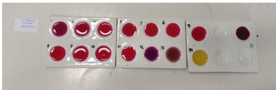
Slika 32. Indikator od svježih bobica vinobojke i metanola.
