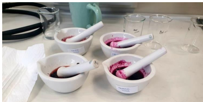
Slika 22. Indikatori pripremljeni od bobica vinobojke i odabranog otapala.
