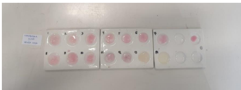
Slika 24. Indikator od suhih bobica vinobojke i vruće vode.
