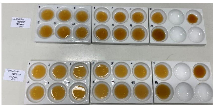
Slika 42. Indikator pripremljen od suhe japanske trešnje i metanola.
