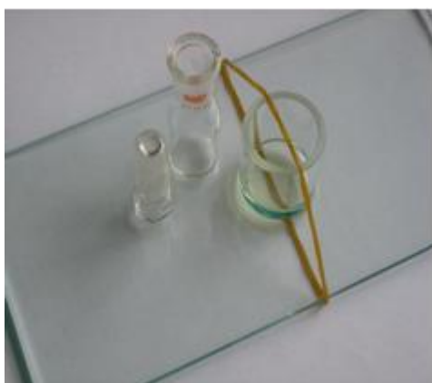
Slika 8: Izrada senzorske PVC membrane za tenzidnu elektrodu
