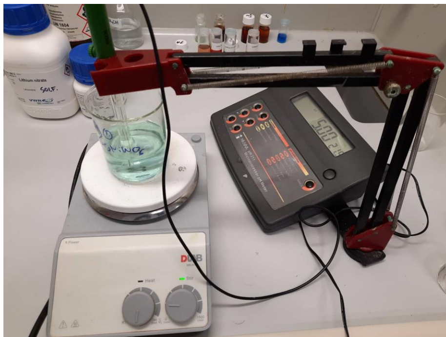
Slika 12. Podlašavanje pH vrijednosti otopine pomoću koncentrirane otopine amonijaka.
