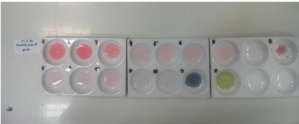
Slika 178. Indikator pripremljen od svježe aronije u etanolu, 15. 4. 2022.
