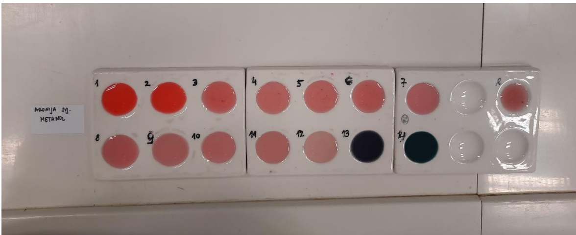
Slika 143. Indikator pripremljen od svježe aronije u metanolu, 3. 5. 2022.
