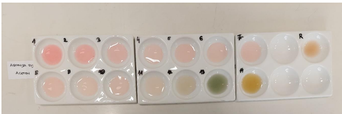
Slika 84. Indikator pripremljen od svježe aronije u acetonu, 22. 2. 2022.
