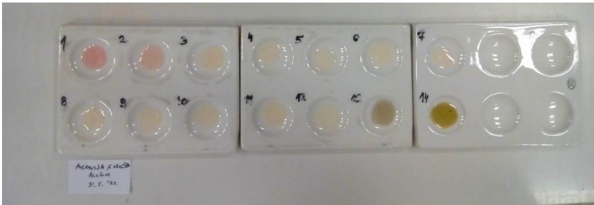
Slika 112. Indikator pripremljen od svježe aronije u acetonu, 31. 5. 2022.
