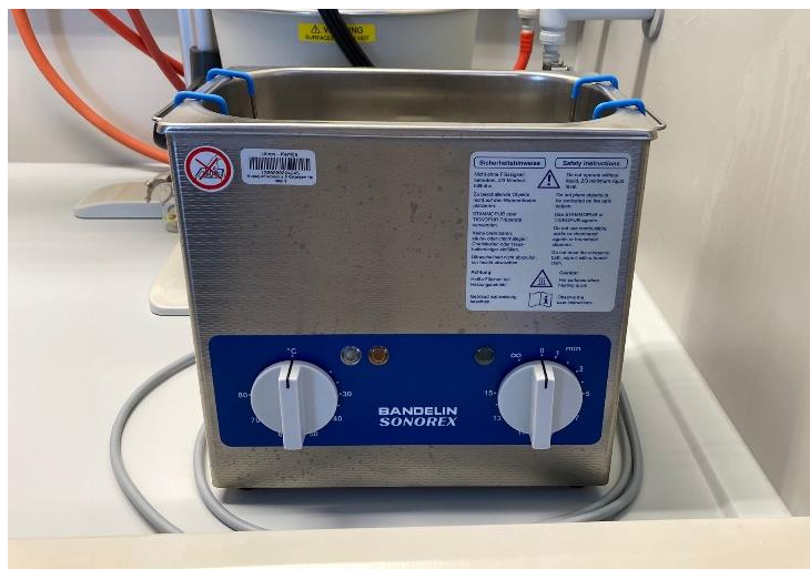
Slika 12. Ultrazvučna kupelj s regulatorom temperature.
