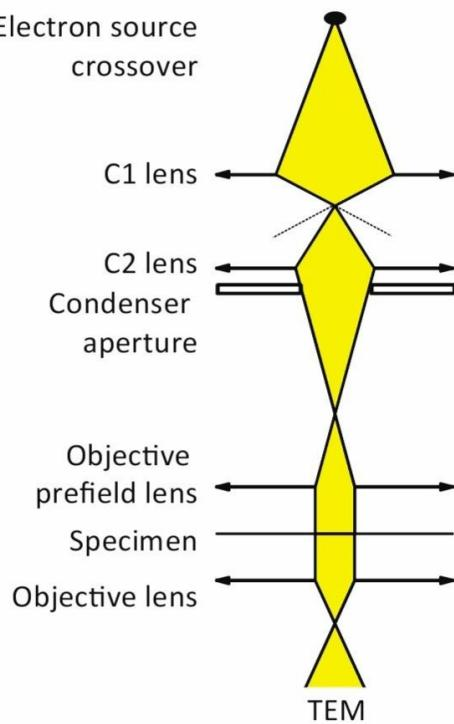
**Slika 9.** Shema dijelova uređaja za transmisijsku elektronsku mikroskopiju [40].
