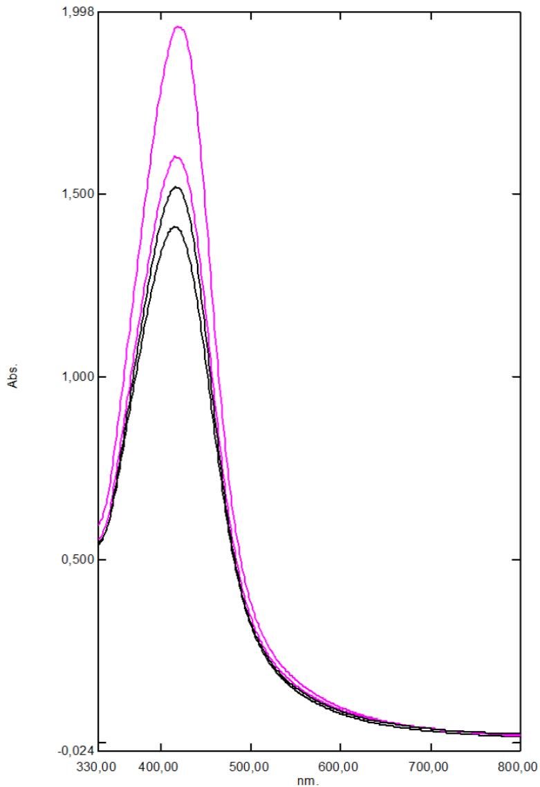
**Slika 12.** Apsorpcijski spektar nanočestica srebra pri  $c=3$  mM, temperatura= $80^{\circ}\text{C}$ , pH 7, omjer 1:9.
