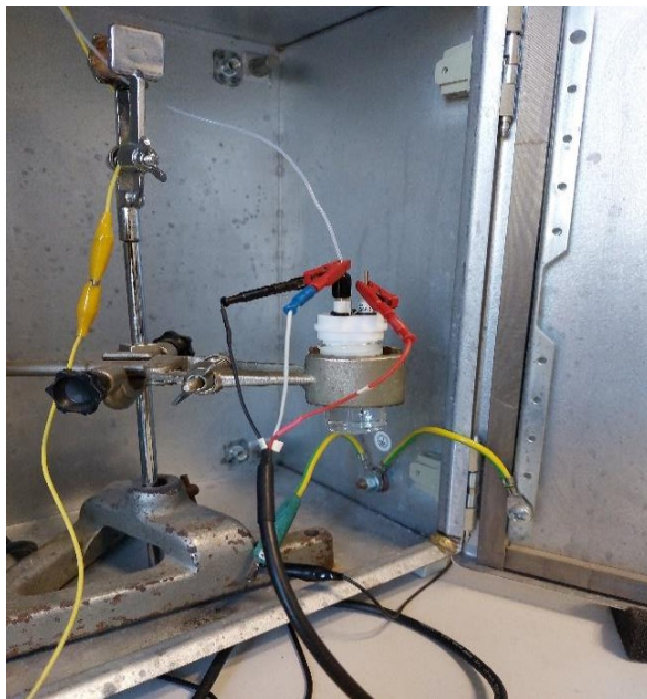
Slika 9. Prikaz troelektrodnog sustava u elektrokemijskoj ćeliji.
