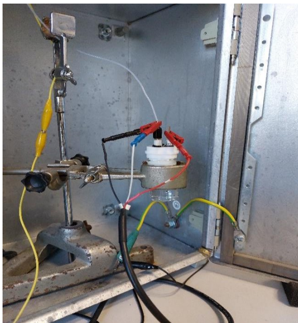
Slika 9. Prikaz troelektrodnog sustava u elektrokemijskoj ćeliji.
