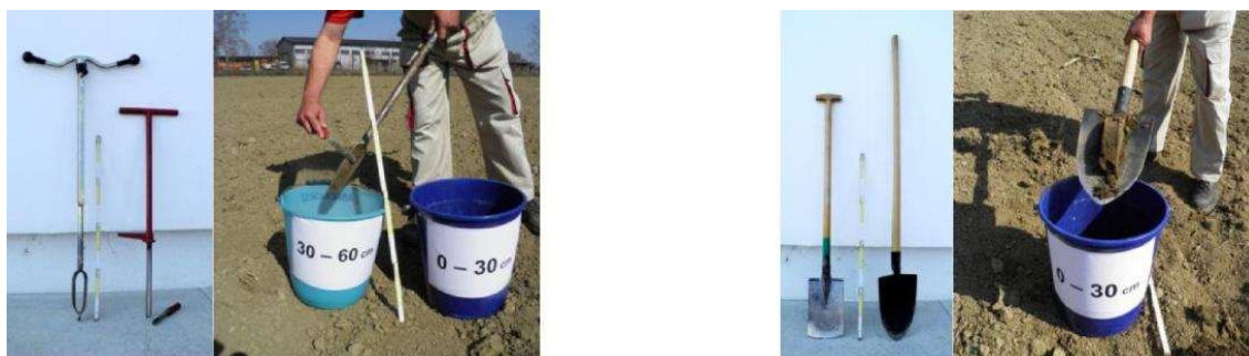
Slika 6. Uzorkovanje tla sondom i štijačem [31].
