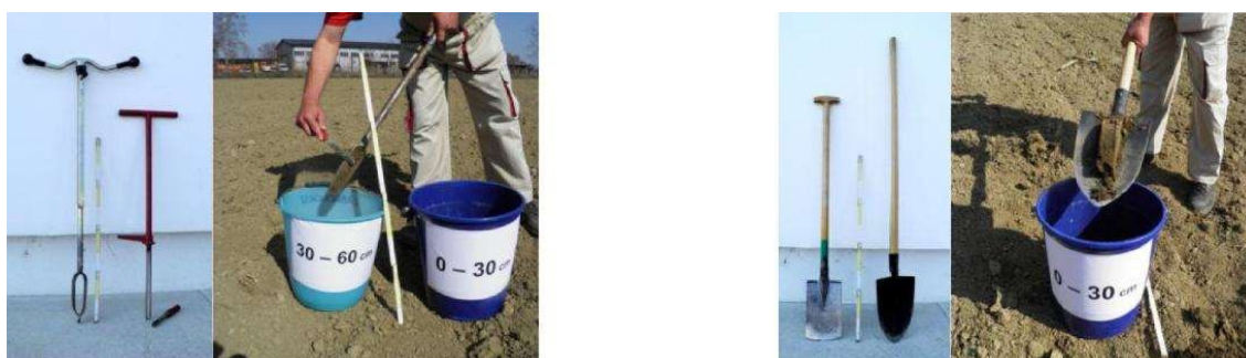
Slika 6. Uzorkovanje tla sondom i štijačom [31].
