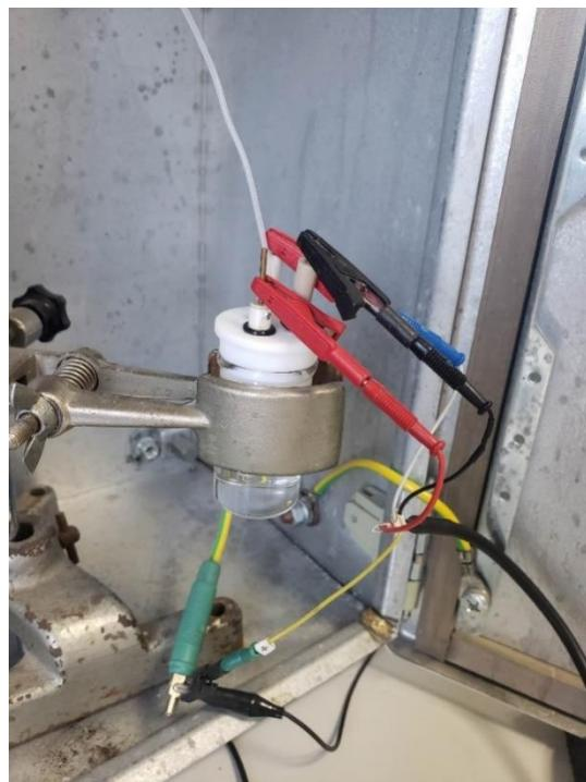
Slika 10. Troelektrodni sustav za voltametrijska mjerena.
