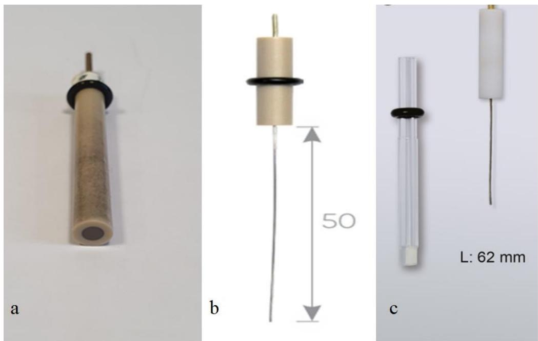
Slika 11. a) Elektroda od staklastog ugljika, b) Platinska žica, c)  $\text{Ag}/\text{Ag}^+$  elektroda za nevodeni medij.
