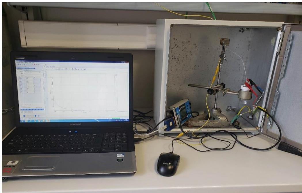
Slika 12. Aparatura za voltametrijska mjerena.
