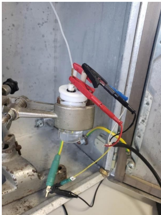
Slika 10. Troelektrodni sustav za voltametrijska mjerenja.
