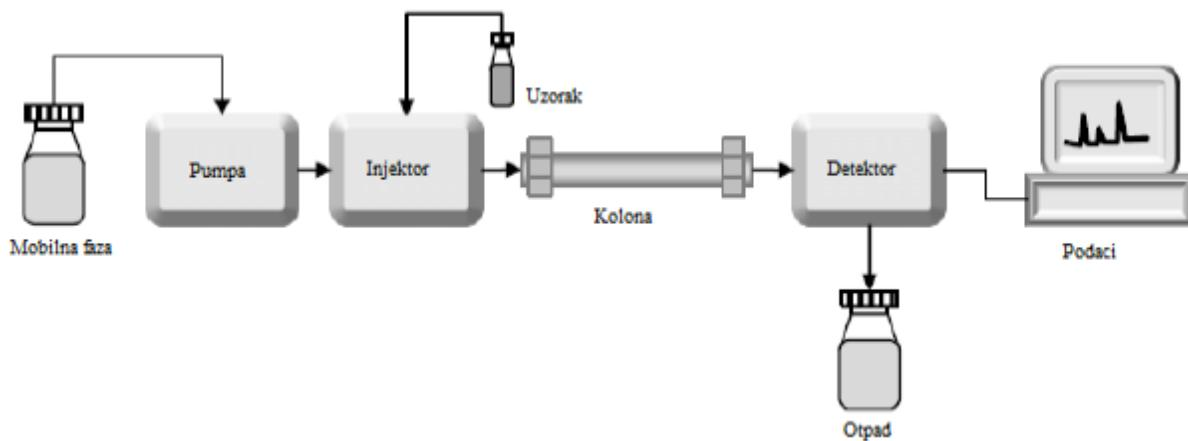
Slika 7. Shematski prikaz HPLC uređaja. [19]
