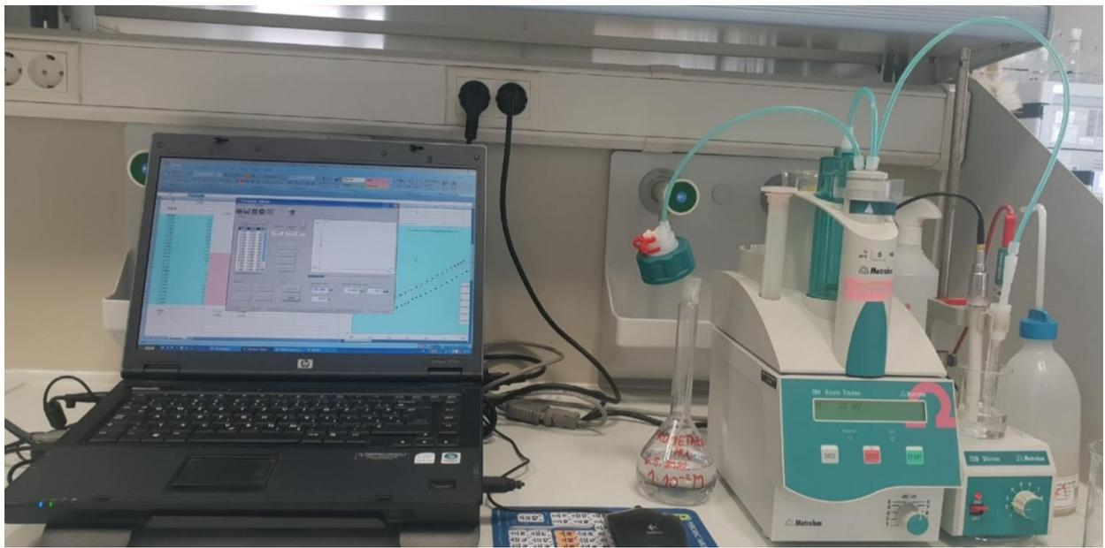
SLIKA 5. Aparatura za direktnu potenciometriju.
