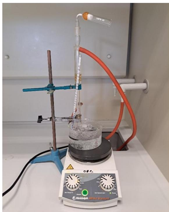
**Slika 10.** Fotografija aparature korištene za refluxiranje pri sintezi MWCNT–OSO<sub>3</sub>H.
