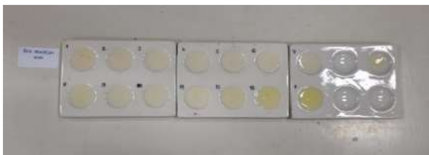
Slika 26. Indikator od latica žute orhideje i vode.
