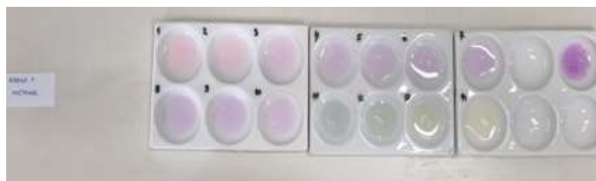
Slika 48. Indikator od latica roza orhideje i metanola.
