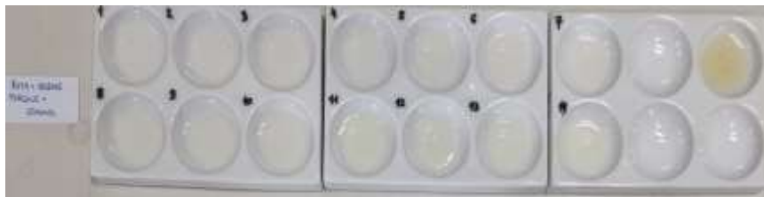
Slika 45. Indikator od latica žute orhideje s roza pjegicama i etanola.
