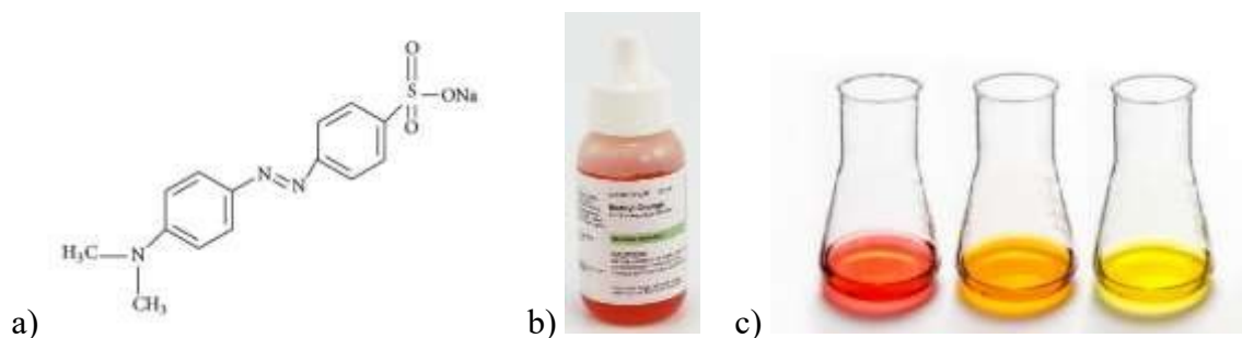
Slika 13. Struktura [34], b) bočica [35] i c) promjena boje metiloranža u kiselom (lijevo) i bazičnom mediju (desno) [36].
