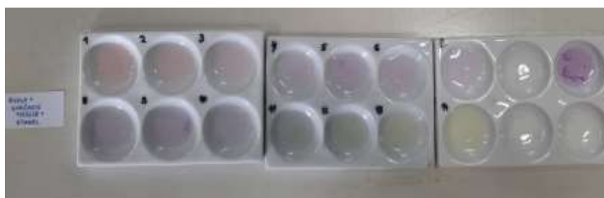
Slika 43. Indikator od latica bijele orhideje s ljubičastim pjegicama i etanola.
