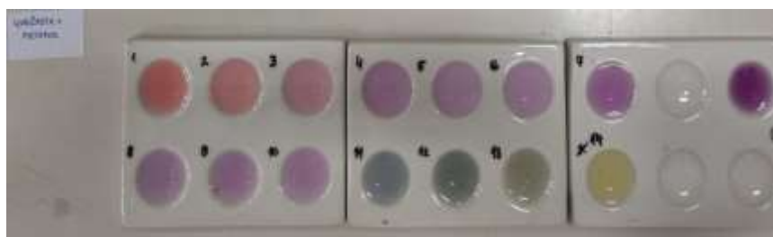
Slika 49. Indikator od latica ljubičaste orhideje i metanola.
