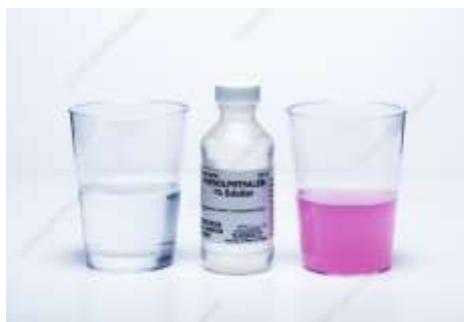
Slika 14. Promjena boje fenolftaleina u kiselom (lijevo) i bazičnom mediju (desno) [38].
