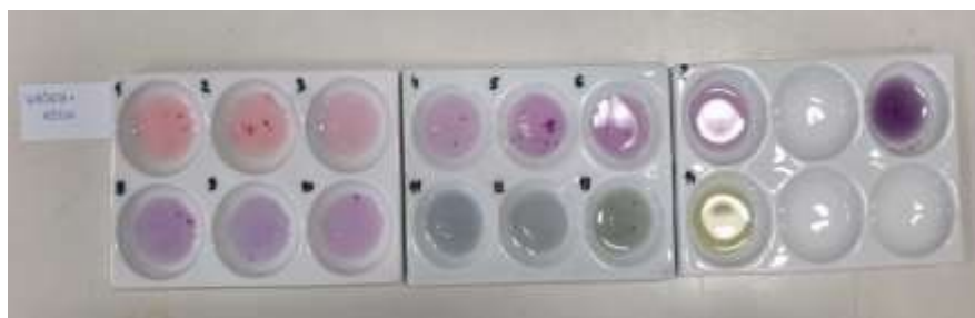
Slika 35. Indikator od latica ljubičaste orhideje i acetona.
