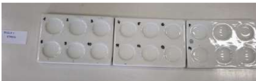
Slika 39. Indikator od latica bijele orhideje i etanola.
