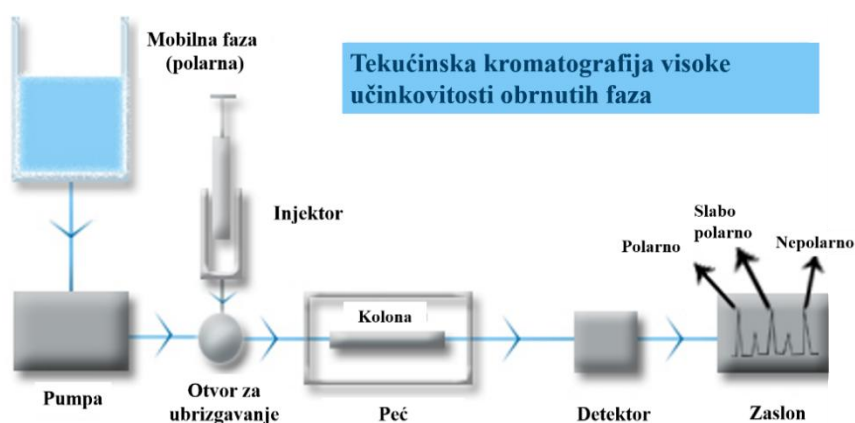
Slika 6. Shematski prikaz RP-HPLC [41]
