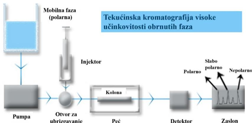
Slika 6. Shematski prikaz RP-HPLC [41]
