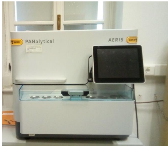
Slika 5. AERIS PANalytical X-ray difraktometar
