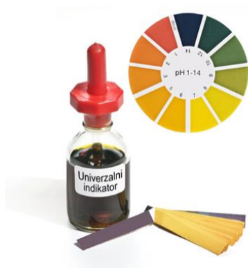
Slika 13. Otopina i papir univerzalnog indikatora te tablica boja [51].
