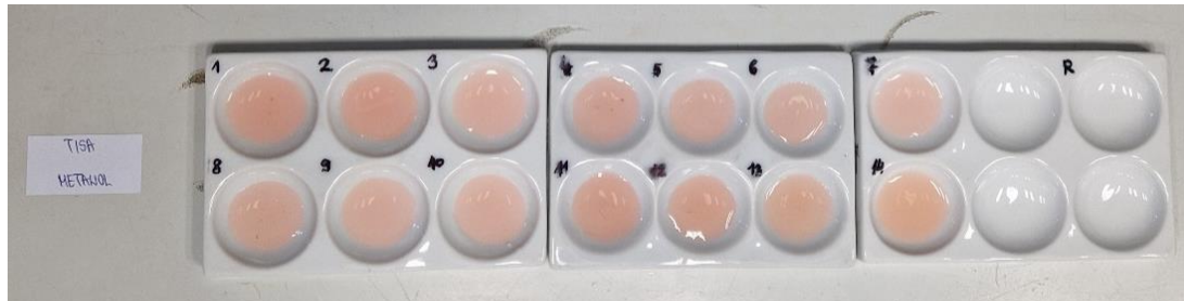
Slika 19. Indikator pripremljen od bobica tise i metanola.
