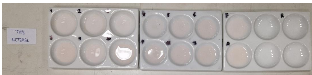
Slika 24. Indikator pripremljen od bobica tise i metanola nakon 24 sata.
