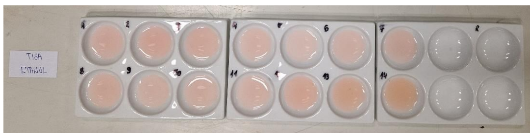
Slika 25. Indikator pripremljen od bobica tise i etanola nakon 24 sata.
