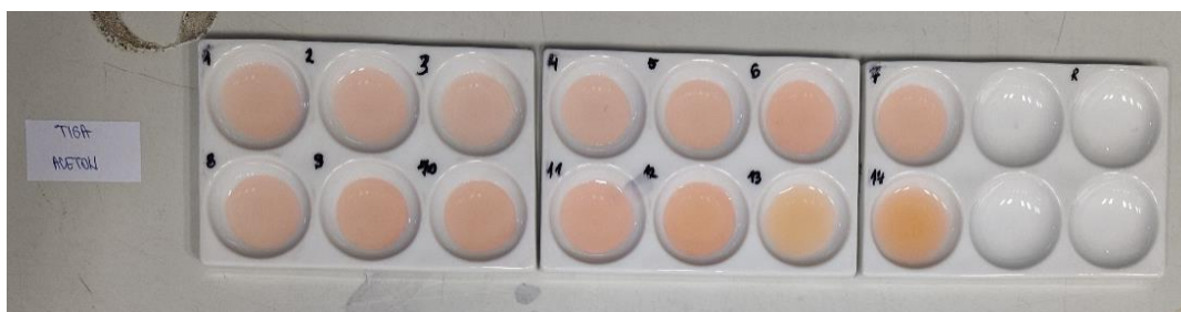
Slika 21. Indikator pripremljen od bobica tise i acetona.
