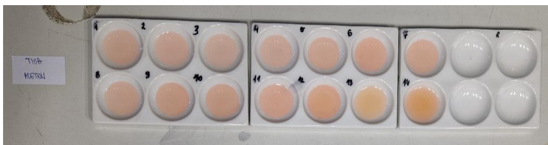
Slika 21. Indikator pripremljen od bobica tise i acetona.
