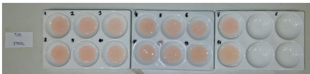
Slika 20. Indikator pripremljen od bobica tise i etanola.
