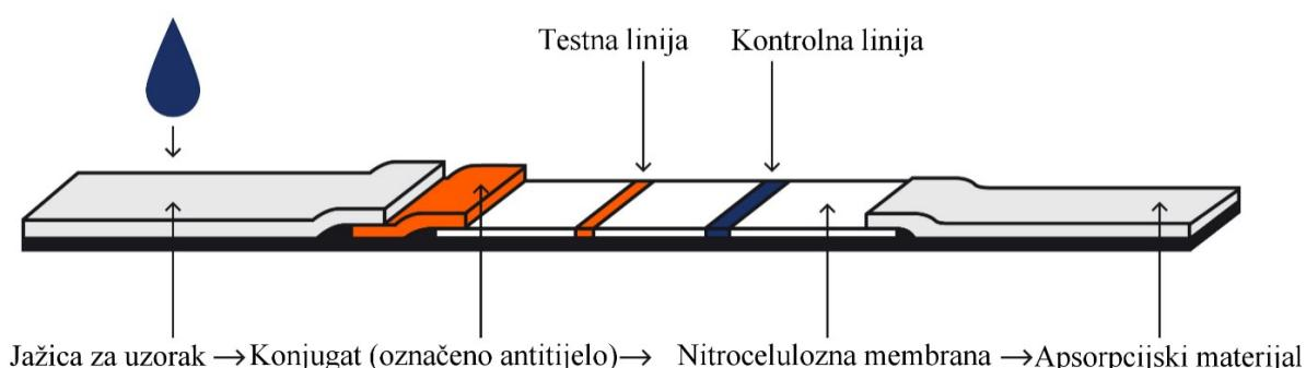
Slika 6. Dijelovi testne pločice LFIA (preuzeto i prilagođeno iz <sup>27</sup>).
