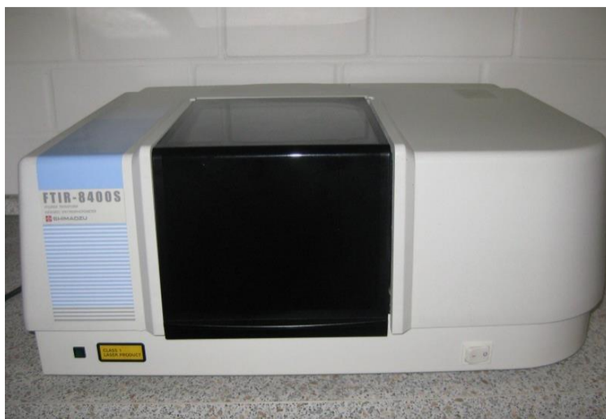
Slika 20. Shimadzu FTIR 8400S uređaj [42].
