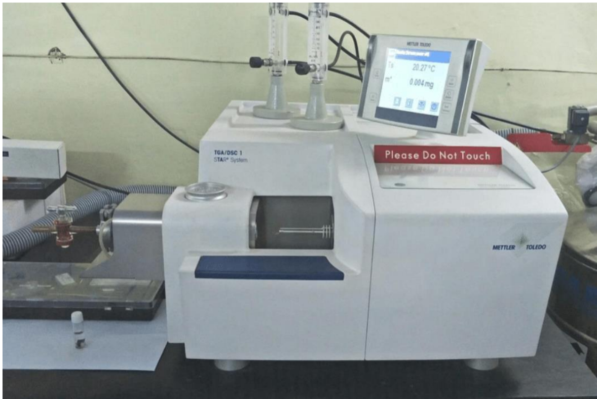
Slika 21. TGA-DSC Mettler Toledo System 1 uređaj [43].
