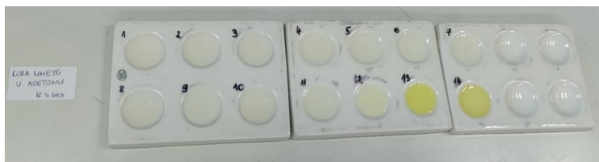
Slika 48. Indikator pripremljen od kore limete i acetona.
