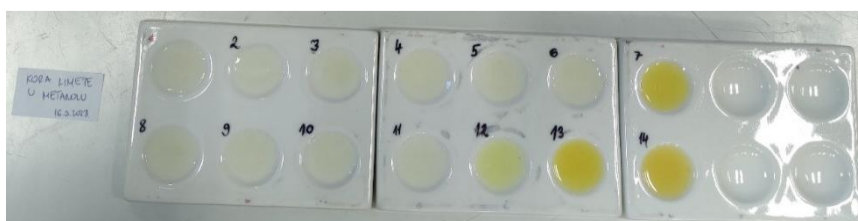
Slika 51. Indikator pripremljen od kore limete i metanola.
