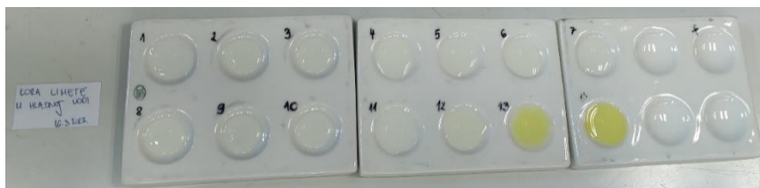
Slika 50. Indikator pripremljen od kore limete i hladne vode.
