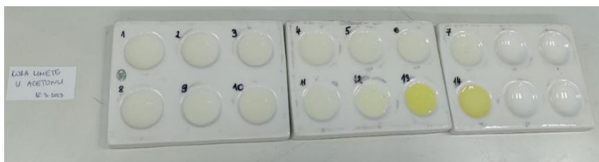
Slika 48. Indikator pripremljen od kore limete i acetona.
