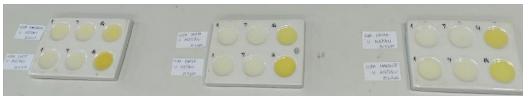
Slika 59. Indikatori pripremljeni od kore citrusa i acetona.
