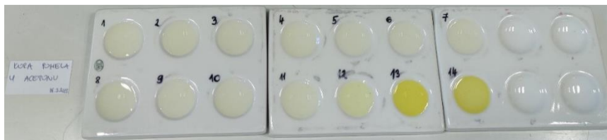
Slika 36. Indikator pripremljen od kore pomela i acetona.
