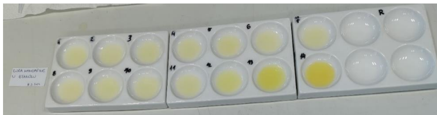
Slika 55. Indikator pripremljen od kore mandarine i etanola.
