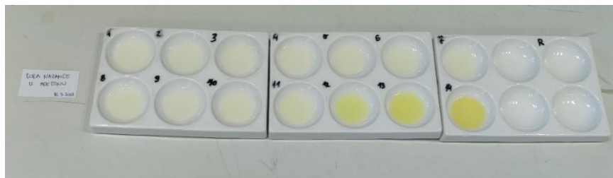
Slika 30. Indikator pripremljen od kore naranče i acetona.
