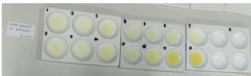
Slika 33. Indikator pripremljen od kore naranče i metanola.
