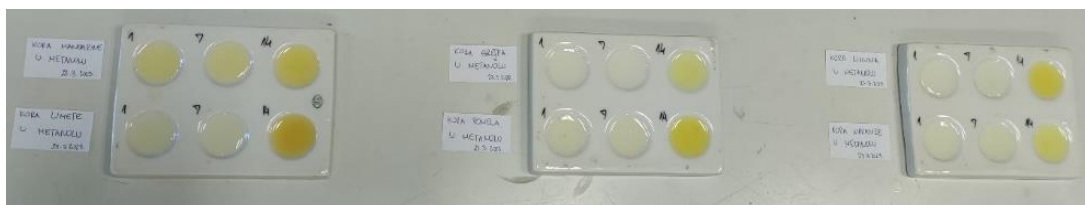
Slika 62. Indikatori pripremljeni od kore citrusa i metanola.
