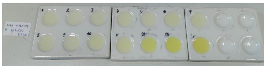
Slika 31. Indikator pripremljen od kore naranče i etanola.
