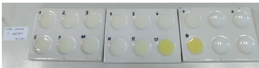
Slika 24. Indikator pripremljen od kore limuna i acetona.
