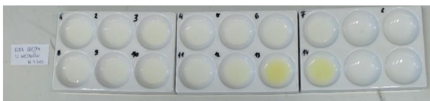
Slika 45. Indikator pripremljen od kore grejpa i metanola.
