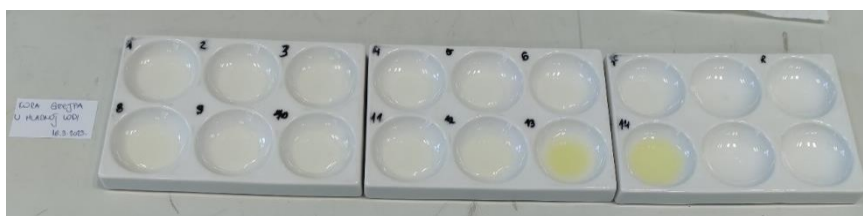
Slika 44. Indikator pripremljen od kore grejpa i hladne vode.
