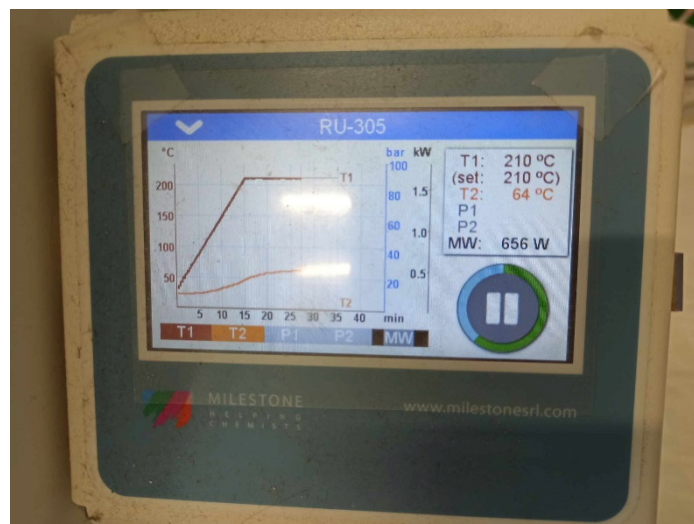
Slika 8. Grafički prikaz temperature i vremena u mikrovalnom uređaju Milestone
