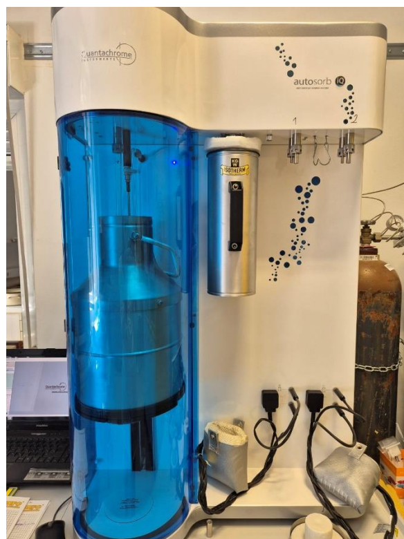
Slika 15. Uređaj za fizisorpcijsku analizu sintetiziranih spojeva.
