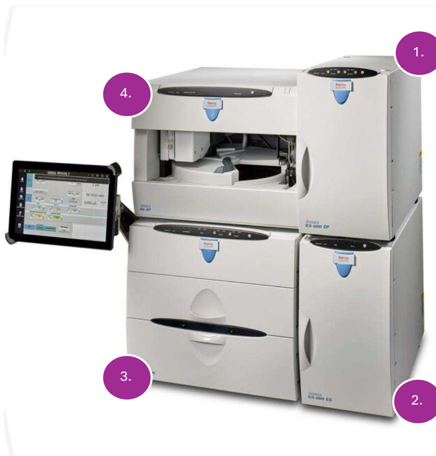
Slika 1. Uređaj za ionsku kromatografiju Dionex ICS-6000. Broj 1 – dualna pumpa, broj 2 – eluens generator, broj 3 – termostatirana komora, broj 4 – autosampler [17].
