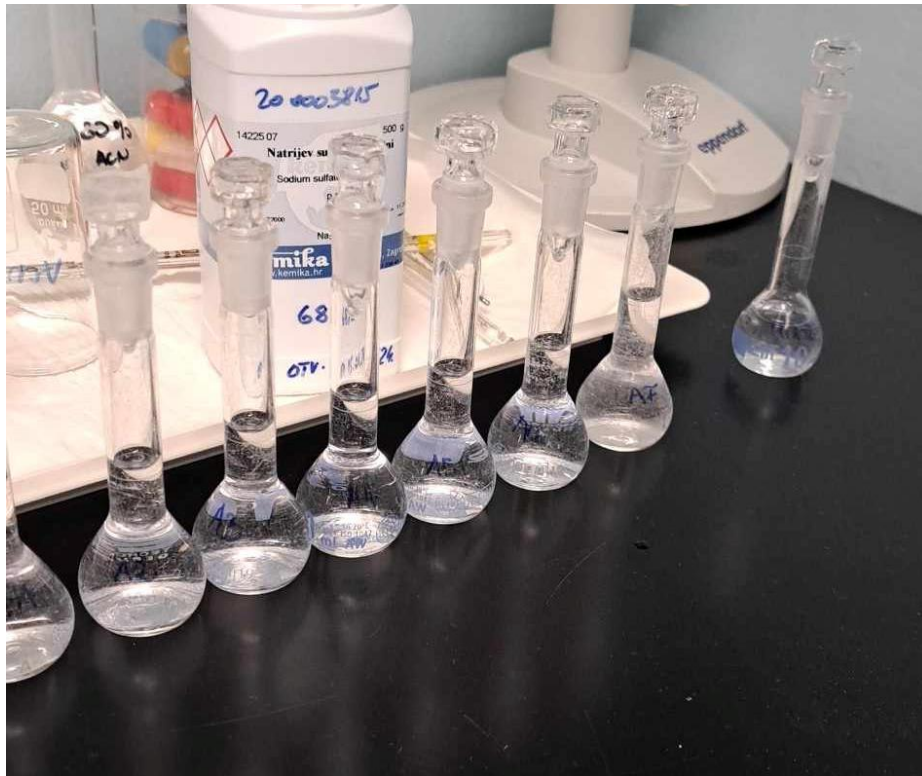
Slika 2. Odmjerne tikvice u kojima su se pripravile otopine za kalibraciju i spike
