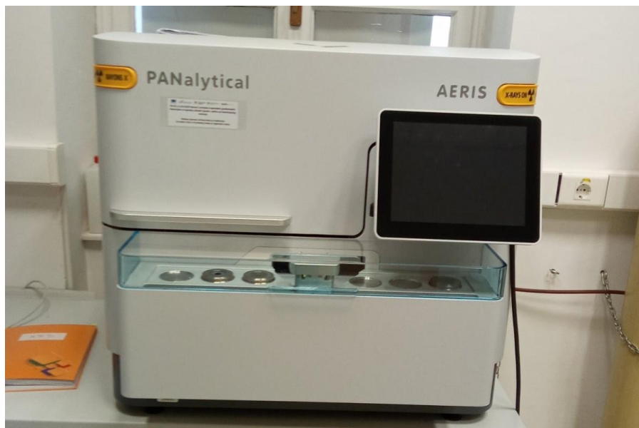
Slika 7. AERIS PANalytical X-ray difraktometar
