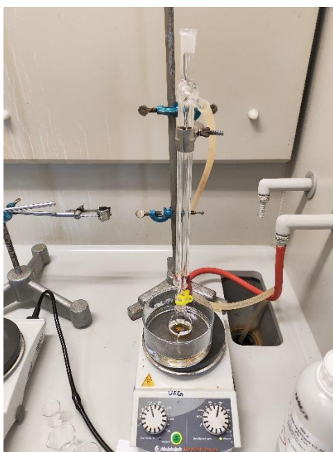
Slika 16. Aparatura za sintezu N-dodecil-4-azido-1,8-naftalimida.
