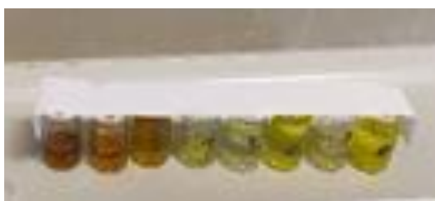
Slika 20. Dobivene frakcije produkata otopljene u acetonu.
