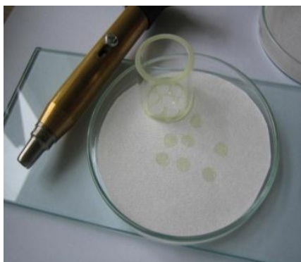
Slika 8. Prikaz izrade membrane ionsko selektivne elektrode
