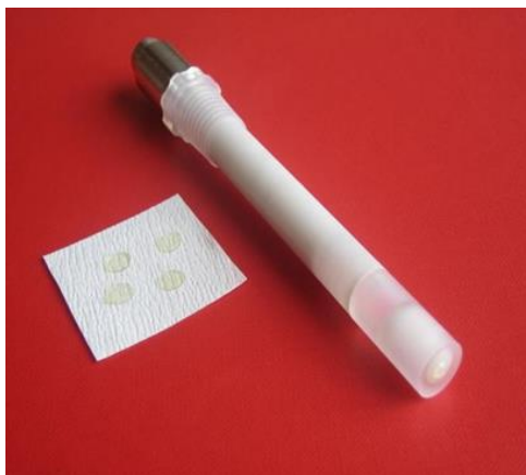
Slika 8. Tenzidna selektivna elektroda za određivanje tenzida
