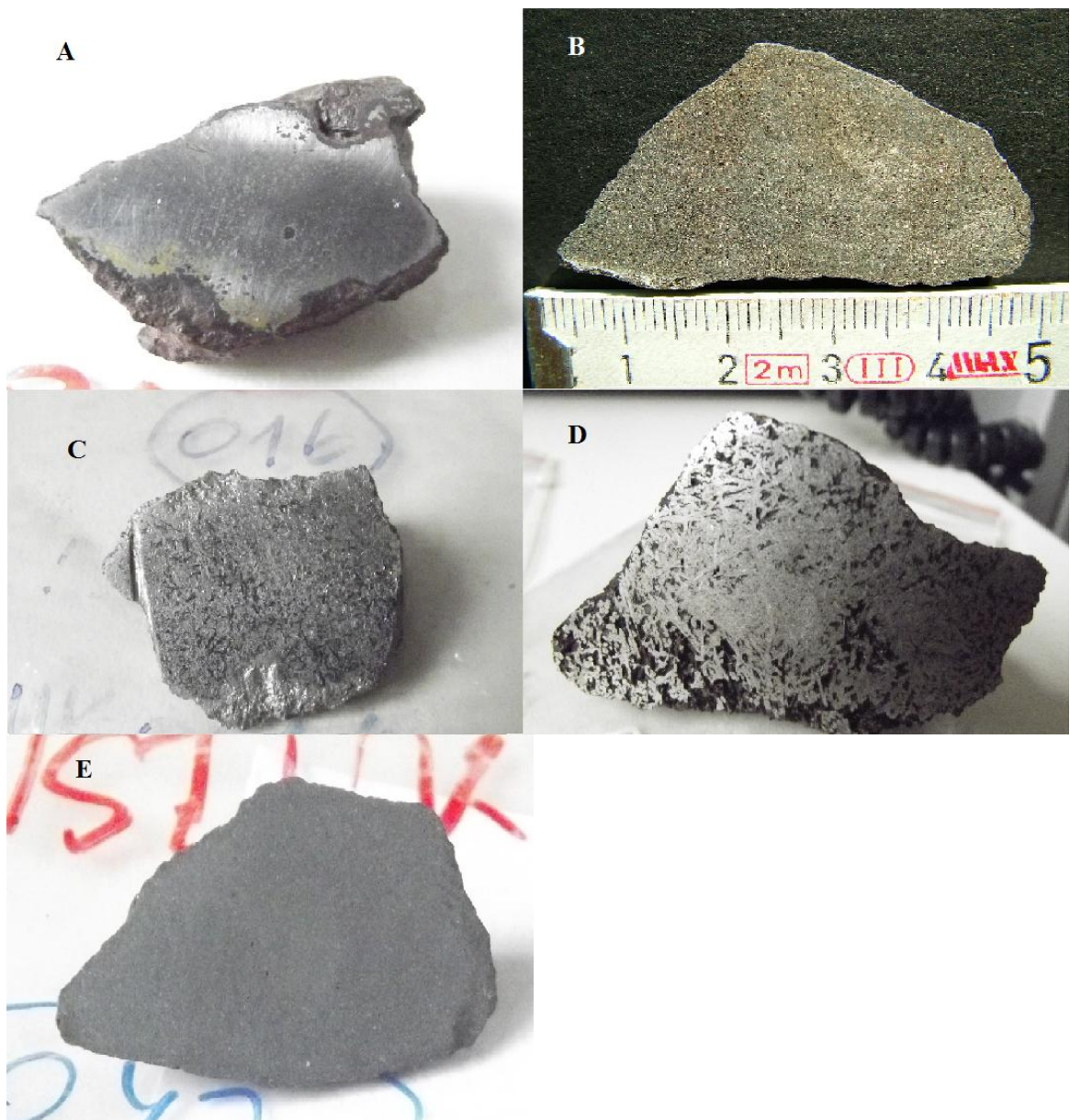
Slika 18. Uzorci nakon poliranja brusnim prahovima 400, 800 i 1200: A) 001, B) 004, C) 016, D) 041 i E) 047.
