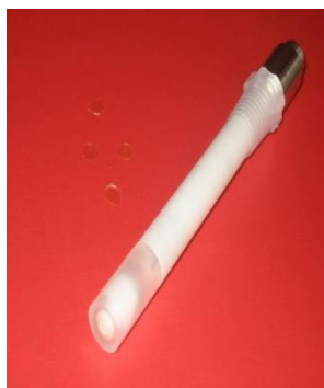
Slika 27. Phillips-ova indikatorska elektroda [12]
