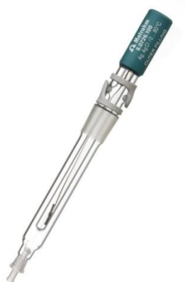
Slika 28. Referentna srebro/srebrov (I) klorid elektroda [13]
