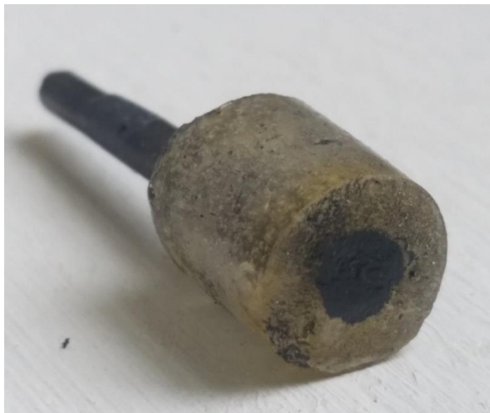
Slika 12. 20E24 CNT tenzidni senzor
